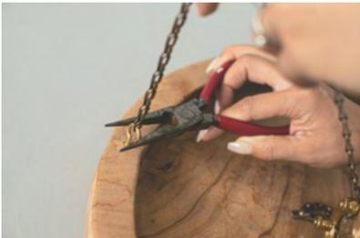
12. Um das lose Ende jeder Kette an der Seilhülle zu sichern, führen Sie jeweils eine Schraube Nr. 6 durch ein Loch in der Messingkonstruktion ein, gefolgt von der Kette, der Unterlegscheibe und der Sechskantmutter.
