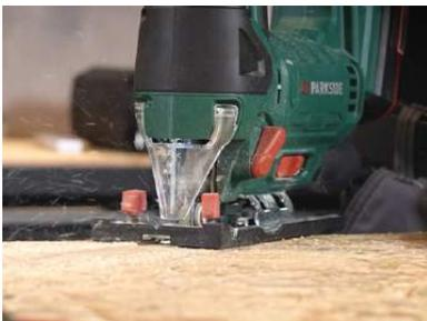
**3.** Kreise mit der Akku-Pendelhubstichsäge aussägen. Mit Schleifpapier die Kanten der Kreisplatten etwas glätten.
