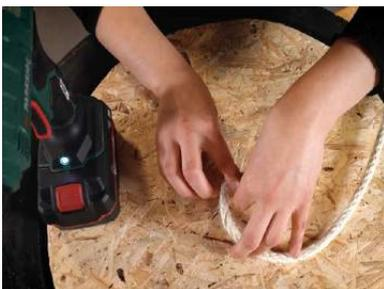
**5.** Jetzt wird geklebt! Den Mittelpunkt der oberen Platte markieren. Von diesem Anfangspunkt aus das Seil spiralförmig rundherum um den Reifen kleben, bis dieser vollständig bedeckt ist.
