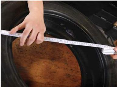
**1.** Zuerst muss das Loch im Autoreifen mit je einer runden Platte von oben und unten bedeckt werden. Dafür die Flächen ausmessen, auf der die Platten aufliegen sollen, hier je  $\varnothing$  43 cm.
